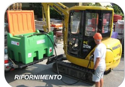
6) Terminato il rifornimento, disattivare l'elettropompa tramite il pulsante d'accensione/spengimento, posizionandolo sulla posizione "0".
